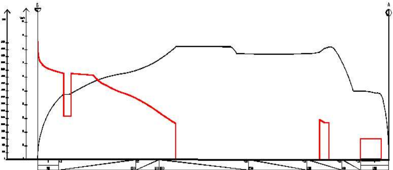
Рис. 24. Пример кривой силы тяги локомотива в функции пути F_k(S) в направлении «обратно»
